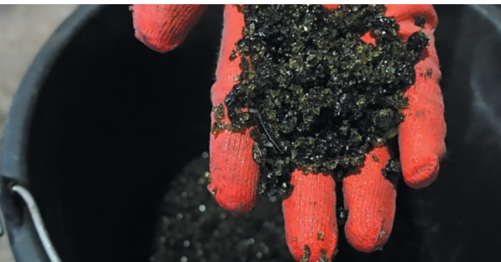
Рис. 1. Конечный продукт процесса – остеклованный гранулированный шлак
